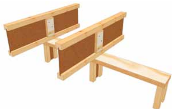
F6 Spojitý nosník na vnitřní stěně
