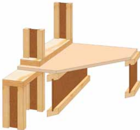
F9 Přípoj výtěžná tabule /stěna
